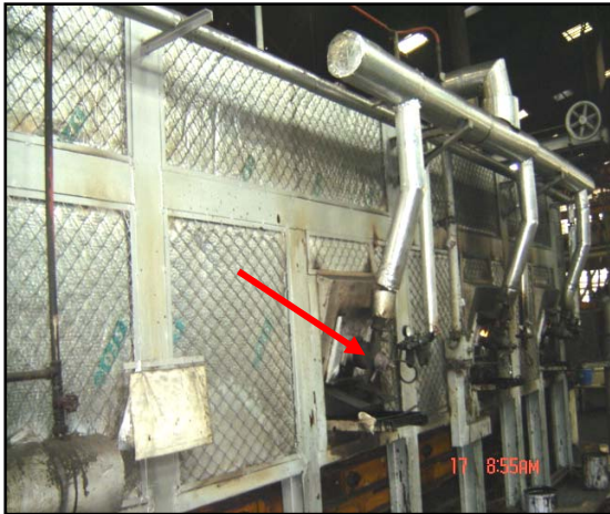
รูปที่ 3.29 แสดงตัวอย่างตำแหน่งหัวเผาของเตาที่ใช้เชื้อเพลิงน้ำมันเตาเกรดซี
